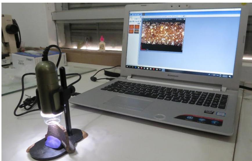
*Fig. 19* Imagen dónde se puede apreciar la toma de imágenes a través del microscopio portátil Dino Lite, modelo AM4113ZT(R4), fuente: Tesista.
