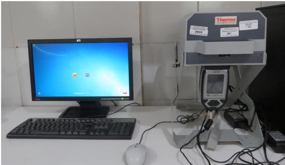
Fig. 20 En la imagen se puede apreciar el aparato de Fluorescencia de Rayos X, conectado a un ordenador para así procesar los resultados, fuente: Tesista.
