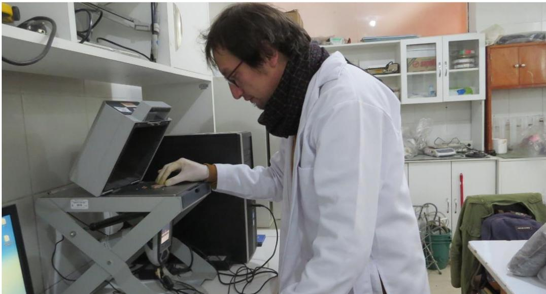
*Fig. 48* Posicionamiento de fragmento de cerámica al seno del equipo pXRF por parte de Nino del Solar Velarde, servidor del DFQ de la DDC de Cusco.
