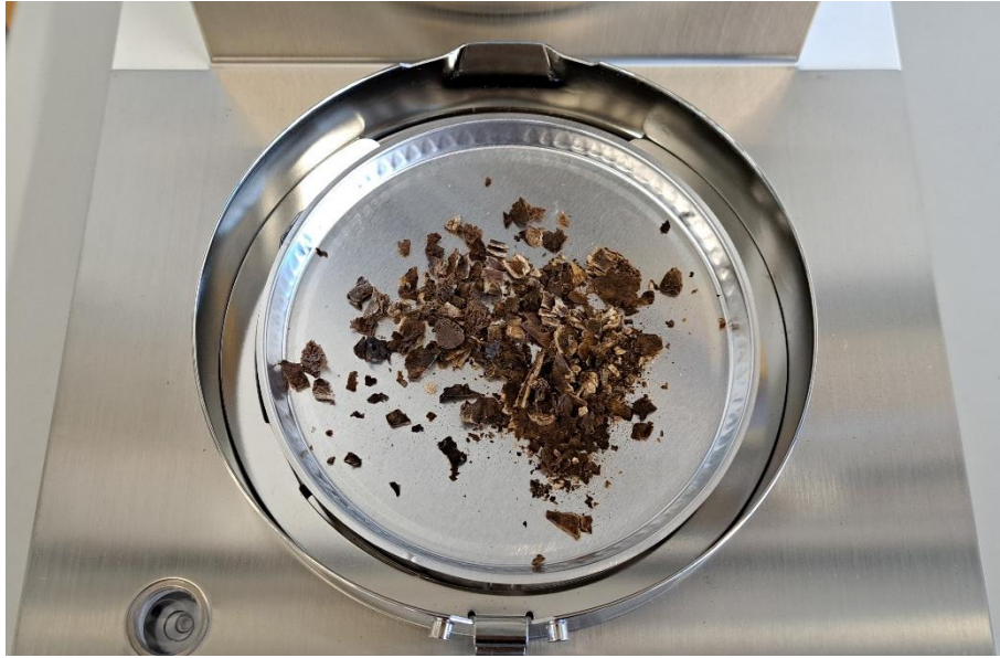
Figura 14. Análisis del contenido del agua de las muestras a través de la termobalanza
