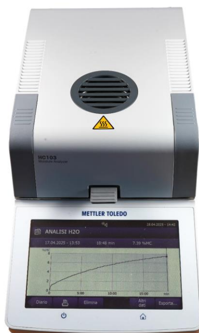
Figura 1. Termobalanza utilizada para el análisis del contenido de agua (MC%). Modelo HC103, Mettler Toledo.
