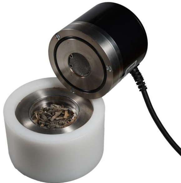
Figura 2. Analizador utilizado para medir la actividad del agua (AW). Modelo Rotronic AW Reader.
