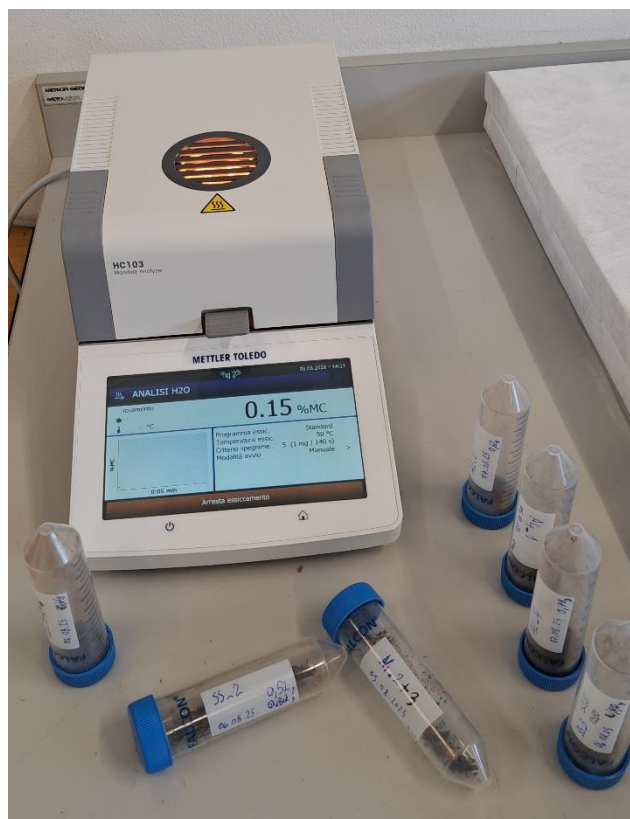
Figura 13. Análisis del contenido del agua de las muestras a través de la termobalanza
