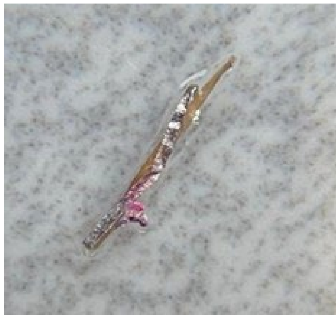
Figura 5. Partes del hilo metálico (HM-03) después de la aplicación del agua regia. Nota. Fotografía propia.
