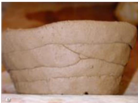
Figura 29. Fisuras en forma de Y acostado.
