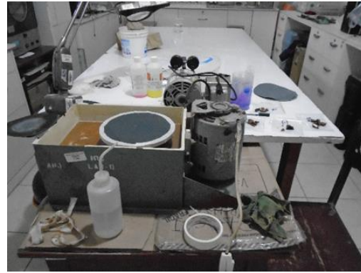
b. Pulidora o lijadora eléctrica provista de un disco rotatorio cubierto con lijas al agua.
