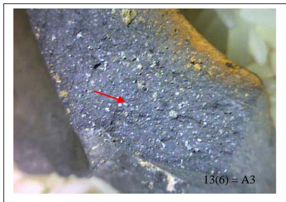
Fotografía 38. Foto de Huella: Masa de arcilla en perfil de pasta en fragmento de cerámica inca de Muyuqmarka del PANS.
