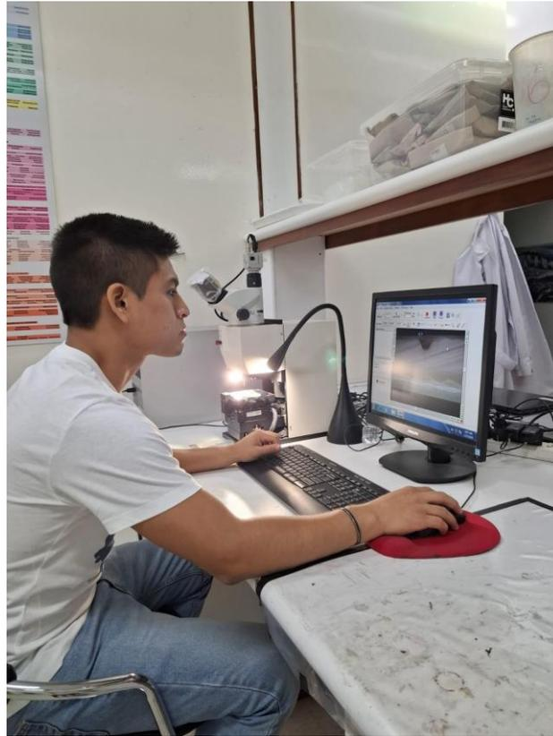
Figura 7. Programación de los parámetros de micromuestreo en el Micromill.
