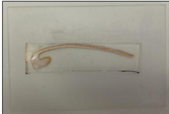
Figura 3. Foto ilustrativa de una muestra (YER3-2), del eje de corte (arriba) y de la lámina montada en vidrio (y pulida) obtenida al final de la preparación.
