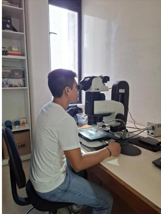
Figura 4. Escaneo fotográfico de las láminas con el estereoscopio Nikon
