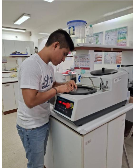
Figura 2. Izquierda: Muestras en resina siendo cortada con sierra de precisión con disco diamantado. Derecha: las láminas de 1-2 mm siendo pulidas empleando flujo de agua desionizada para evitar contaminación.
