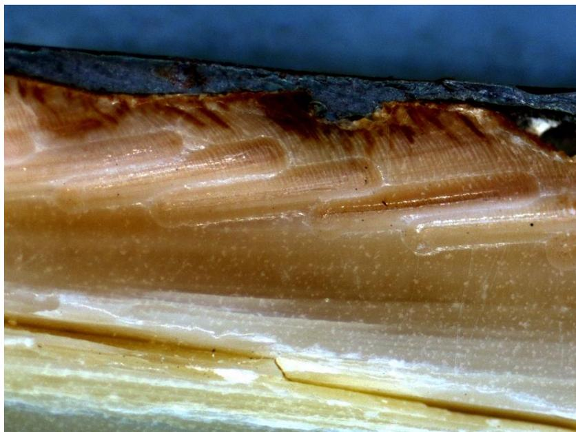
Figura 8. Imagen ilustrativa mostrando un detalle de la muestra YER3-7 donde aparecen los surcos programados y producidos por el microtaladro del Micromill. En cada surco se colectó aproximadamente 0.1mg de polvo de aragonita para análisis isotópico. Esa técnica permite evitar las zonas alteradas en superficie.
